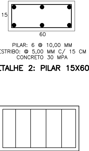
GAIOLA: @ 8,00 MM C/ 15 CM NAS DUAS DIREÇÕES CONCRETO 30 MPA
